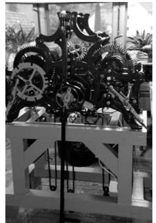
setzt, repariert, wieder eingebaut und mit einem elektrischen Antrieb versehen (ab jetzt müssen nicht mehr jeden Tag die Gewichte per Hand hochgezogen werden.)
